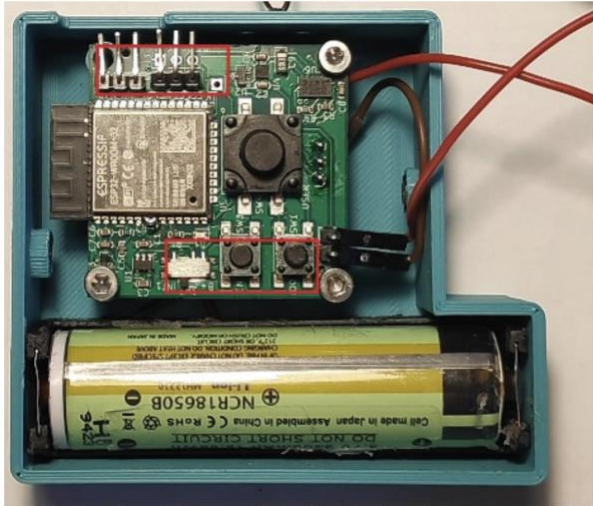
Εικόνα 15 Τρισδιάστατα εκτυπωμένο περίβλημα, μπαταρία ιόντων λιθίου 18650 και ηλεκτρονικά εξαρτήματα ΣΕΠ. Οι περιοχές στο κόκκινο πλαίσιο περιέχουν υλικό που διευκολύνει τον προγραμματισμό και την ανάπτυξη της συσκευής, αλλά μπορούν να παραληφθούν για μείωση του μεγέθους της πλακέτας.
