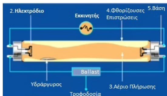
Σχήμα 1: Αναπαράσταση δομής και συνδεσμολογίας λαμπτήρα φθορισμού.
