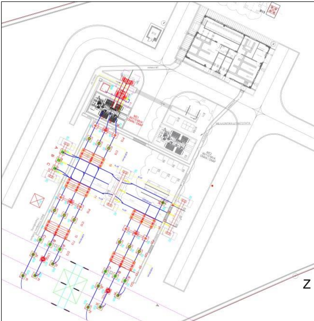
Εικόνα 2.5: Ενδεικτική γενική διάταξη υποσταθμού [38].
