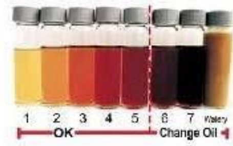
Εικόνα 1.8: Πιθανές αλλαγές στο χρώμα του λαδιού [18].
