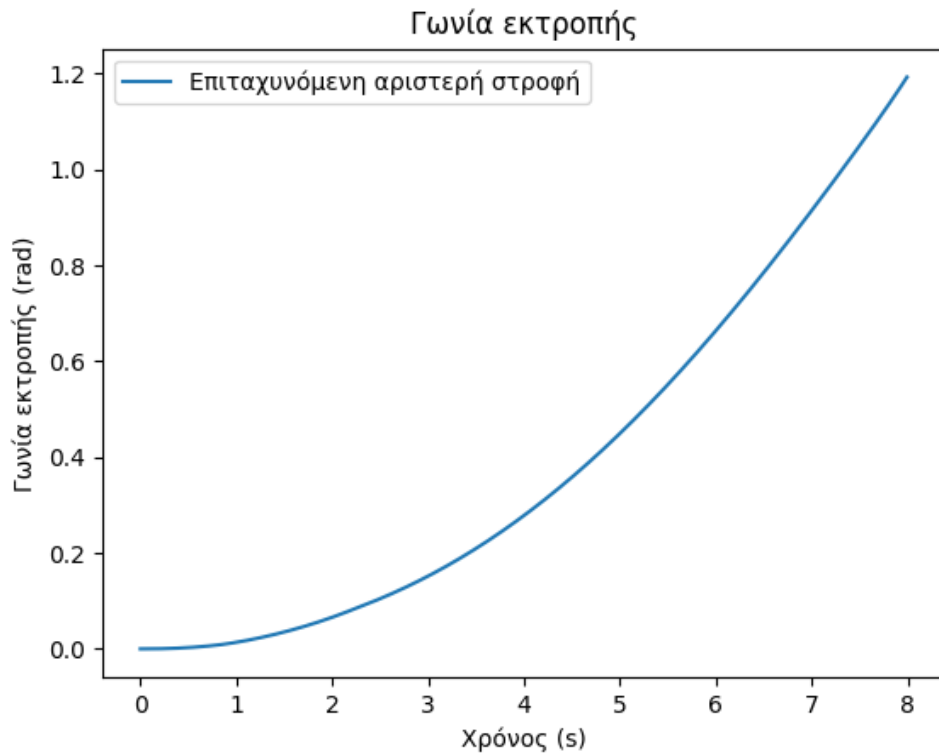
Σχήμα 2.3: Γωνία εκτροπής αριστερής στροφής με v_0 = 15 \text{ m/s} , v_\delta = 0.005 \text{ rad/s} και a_{\text{long}} = 0.2g
