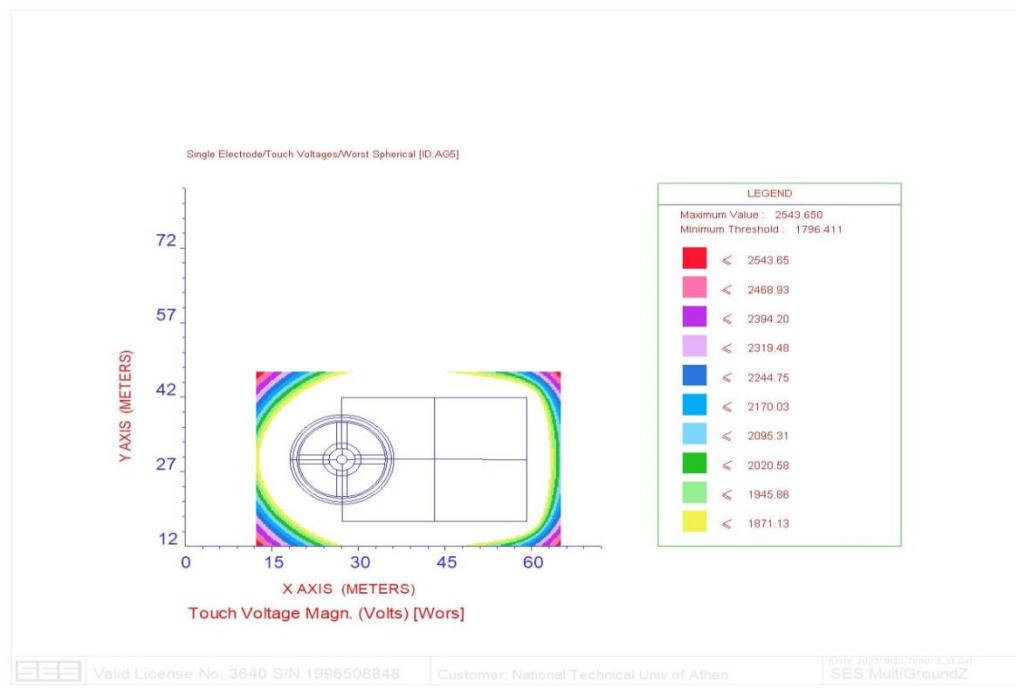
Σχήμα 6.21 Αναπτυσσόμενες τάσεις επαφής στην Α/Γ 5 για σφάλμα διάρκειας 0,5 sec
