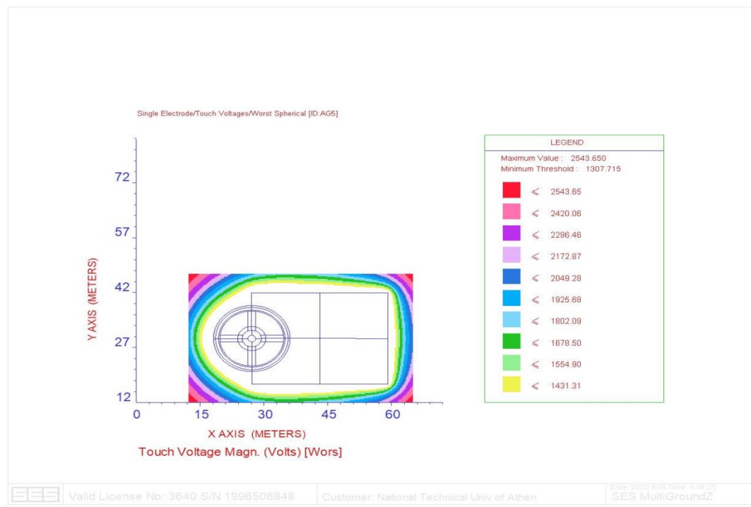
Σχήμα 6.23 Αναπτυσσόμενες τάσεις επαφής στην Α/Γ 5 για σφάλμα διάρκειας 1 sec
