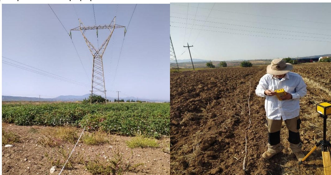
Εικόνα 6.15: Μέτρηση ηλεκτρικού πεδίου κατά μήκος του άξονα της γραμμής.
