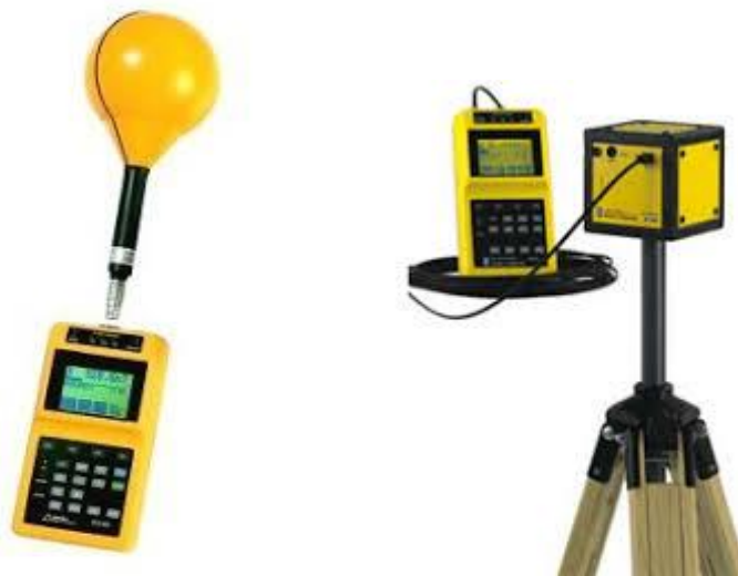
Εικόνα 4.3: Σύνδεση οργάνου μέτρησης με τους αισθητήρες μέτρησης ηλεκτρικού πεδίου (αριστερά) και μαγνητικού πεδίου (δεξιά).
