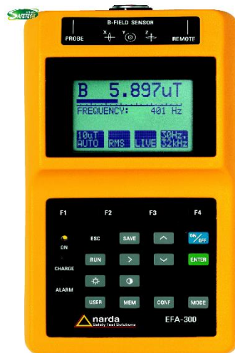
Εικόνα 4.1: Πεδιόμετρο Narda EFA-300.
