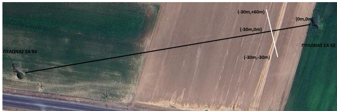
Εικόνα 6.14: Άξονες μέτρησης και θέσεις των αγωγών του τμήματος της γραμμής μεταφοράς ΣΑ92-ΣΑ93 για τον εγκάρσιο άξονα που απέχει 30m από τον Πυλώνα ΣΑ 92.
