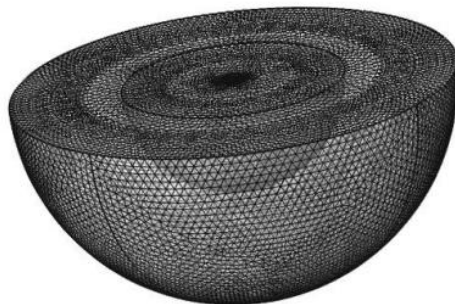
Εικόνα 3.5.1 Τρισδιάστατη γεωμετρία με εξαιρετικά καλής ποιότητας διαίρεση του χώρου. Ημισφαιρικό Ηλεκτρόδιο ακτίνας r=0.5m [26].
