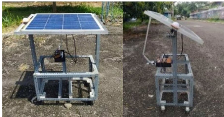
Σχήμα 10: Ηλιακός Ιχνηλάτης με BH1750 και STM32 [24]
