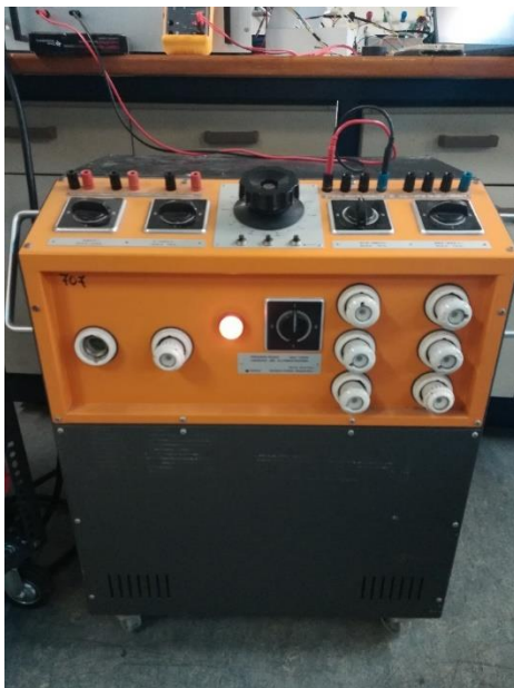
Εικόνα 4.2: Ο μετασχηματιστής τροφοδοσίας του αντιστροφέα.
