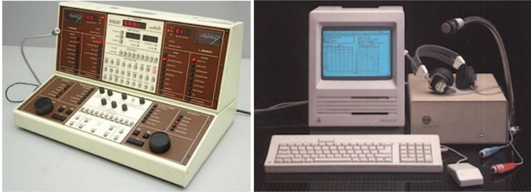
Εικόνα 38: Αριστερά: Ακούμετρο Beltone 2 καναλιών, Δεξιά: Ακούμετρο βασισμένο σε υπολογιστή (“Virtual Corporation Model 320 Clinical Audiometer” βασισμένο σε υπολογιστή Apple) (79).
