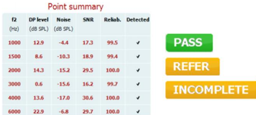
Εικόνα 63: Η σύνοψη των αποτελεσμάτων, με ενσωματωμένα στοιχεία όπως ο δείκτης θορύβου και η επαναληψιμότητα και το αποτέλεσμα όπως προβάλλεται στην οθόνη.
