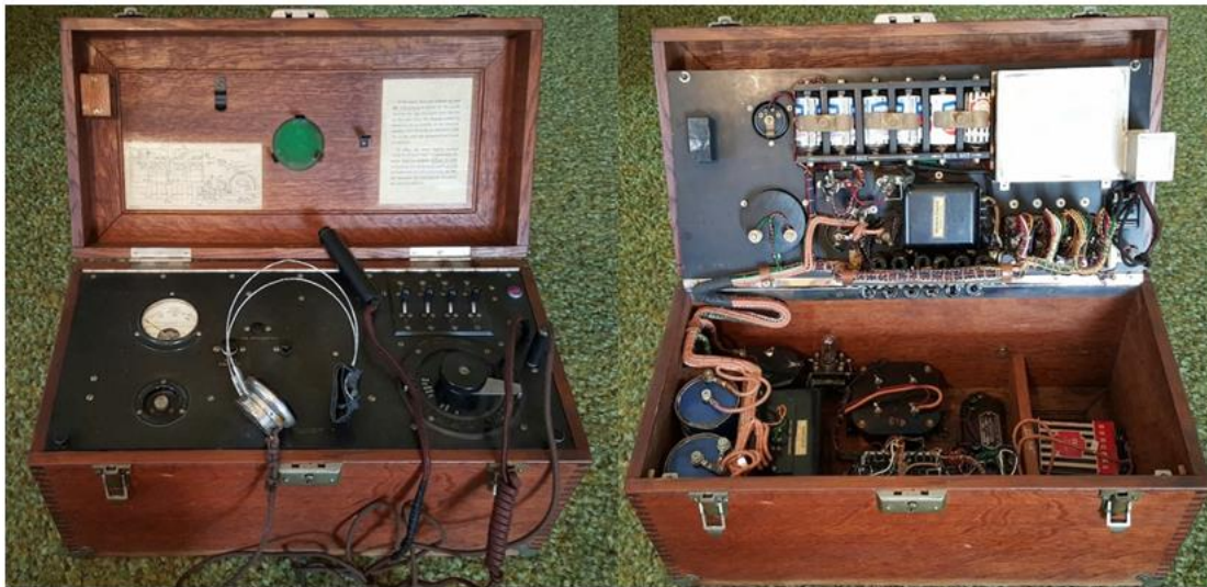
Εικόνα 36: Συσκευή «Western-Electric 2-A» (δεξιά: εσωτερικά ηλεκτρονικά) (81).
