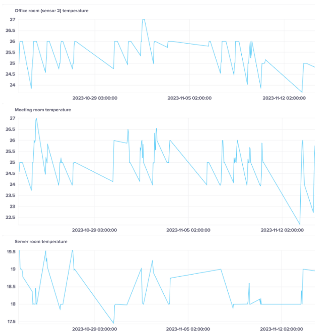
Σχήμα 3.8: Οι σειρές θερμοκρασίας για τα τρία σημεία μέτρησης. Έχουν παραχθεί με εφαρμογή κινούμενου μέσου όρου ανά μία ώρα.
