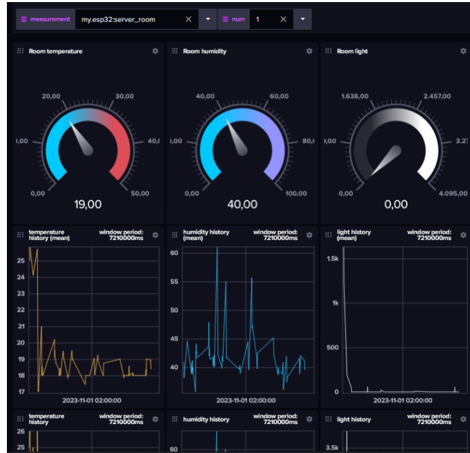
Εικόνα 3.4: Ο πίνακας ελέγχου "Temperature & Humidity by room".
