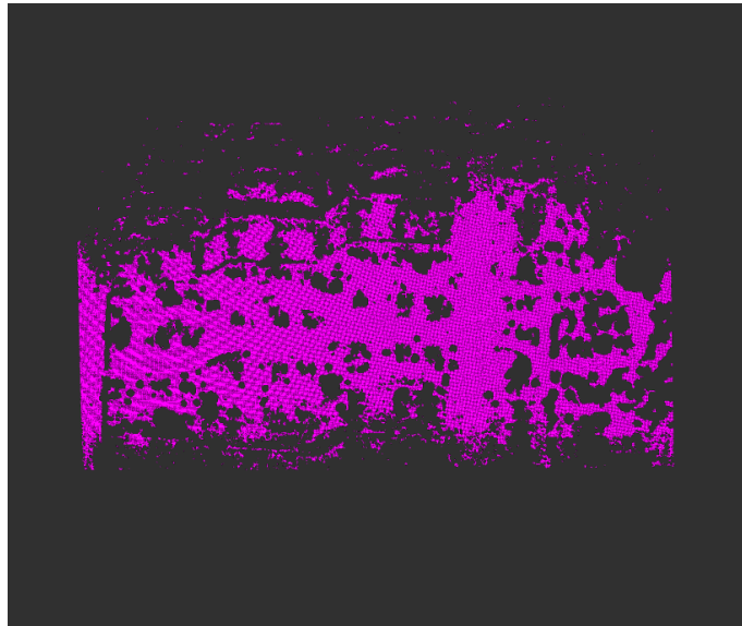
Figure 7. Χάρτης αναπαράστασης της προσβασιμότητας όλου του εξωτερικού χώρου, γνωστός και με τον όρο traversability map .
