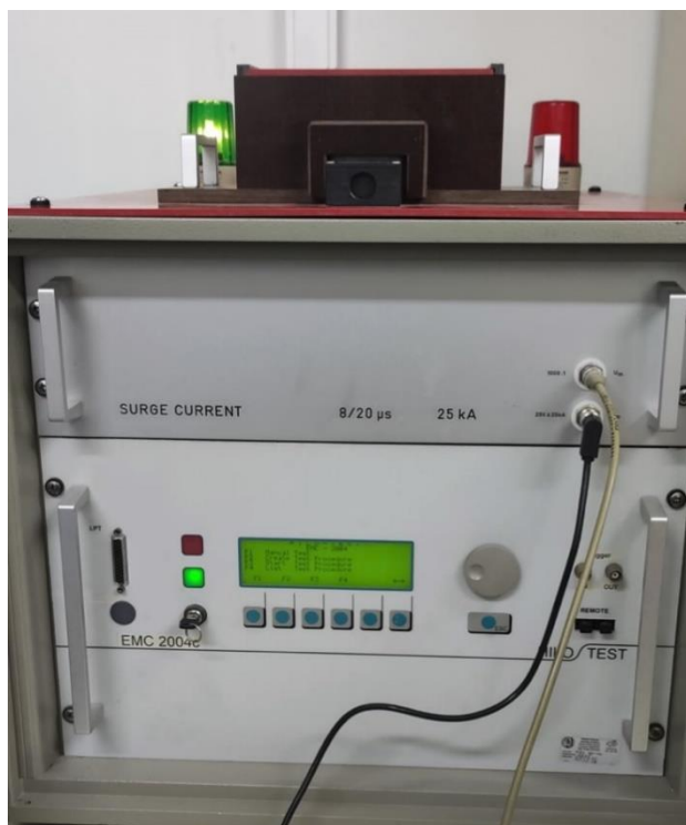
Εικόνα 6.1: Η κρουστική γεννήτρια ρεύματος «HILO/TEST: EMC-2004».
