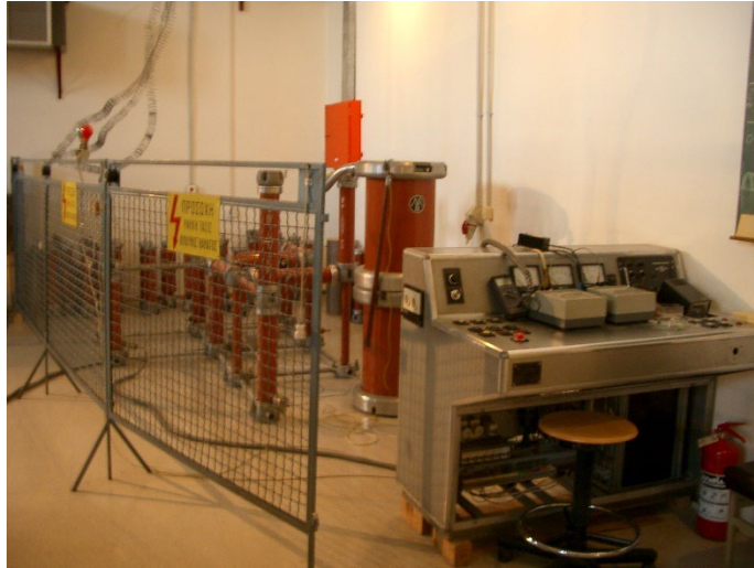
Εικόνα 3.3.1 Διάταξη παραγωγής υψηλής τάσης του εργαστηρίου
