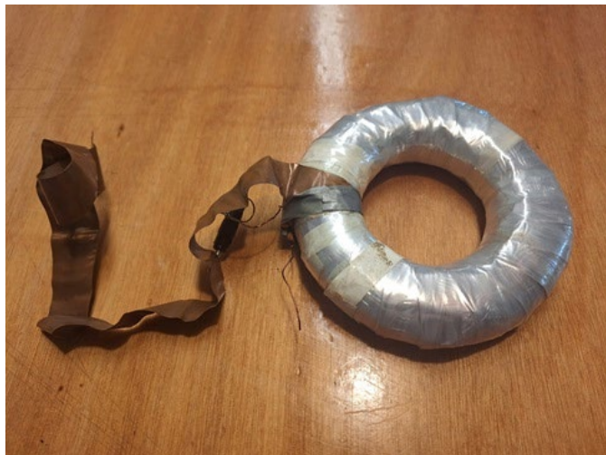
Εικόνα 7.2.1.1 Ο μετασχηματιστής ρεύματος που κατασκευάσαμε
