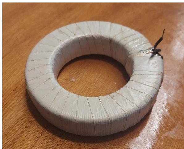
Εικόνα 8.1.1 Πηνίο Rogowski που κατασκευάσαμε
