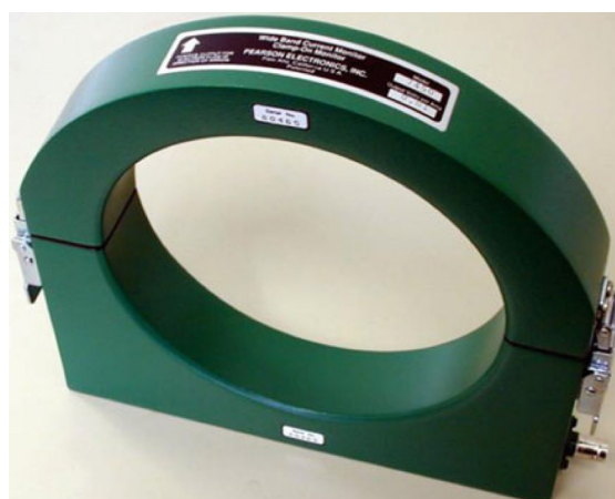
Εικόνα 2.3.5.4. Ευρυζωνικό πηνίο μέτρησης με μαγνητικό πυρήνα και εσωτερικό ολοκληρωτή διαιρούμενου τύπου
