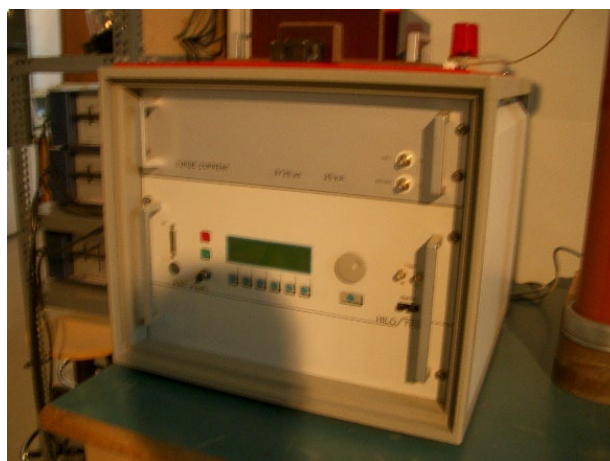
Εικόνα 3.2.1 Γεννήτρια κρουστικού ρεύματος Hilo
