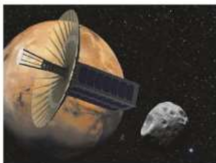
Σχήμα 1: Μία κεραία CubeSat, με χρήση ανακλαστήρα προσαρμοσμένη στη ζώνη Ka-Band (Deep Space Exploration) [12]
