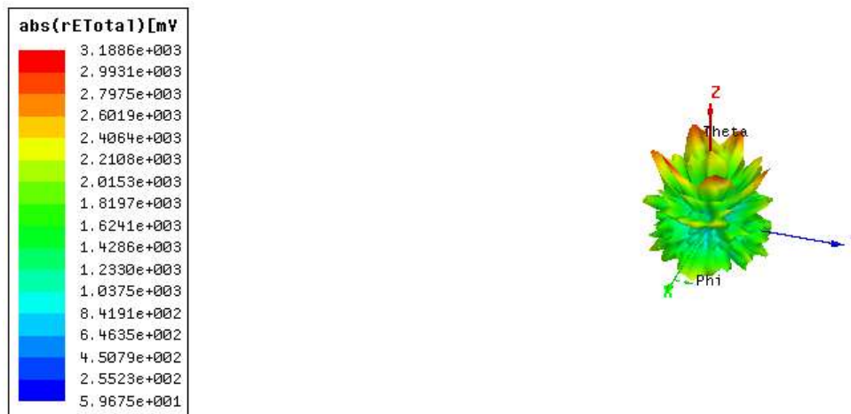
Σχήμα 37: Τρισδιάστατο πολικό διάγραμμα εντάσεως του ηλεκτρικού πεδίου για τη συνολική διάταξη κεραιών του CubeSat
