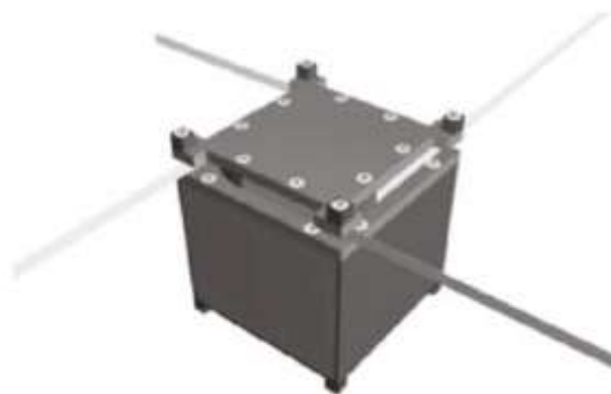
Σχήμα 8: Ο μηχανισμός ανάπτυξης κεραιάς που χρησιμοποιήθηκε στο PolySat [47]
