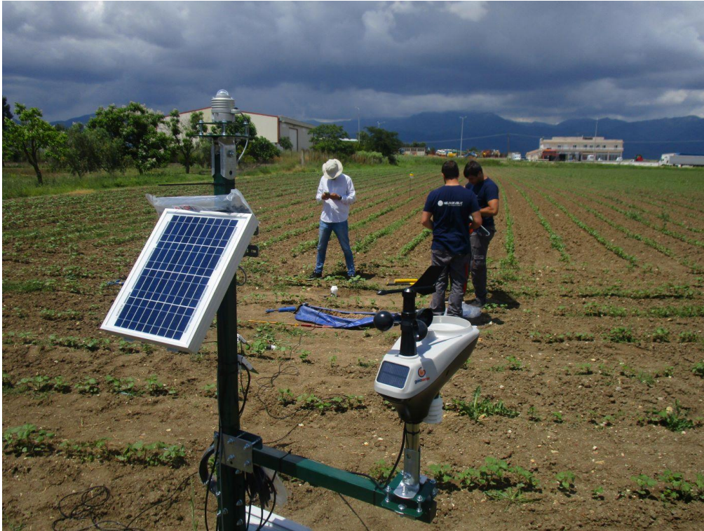
Εικόνα 37. Σύστημα ευφυούς γεωργίας με μετεωρολογικό σταθμό, αισθητήρα εδάφους και εντομοπαγίδες
