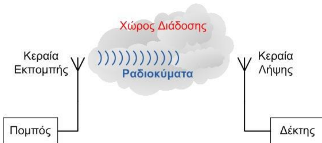
Εικόνα 1 - Γενική αρχιτεκτονική ασύρματου συστήματος μετάδοσης πληροφορίας.
