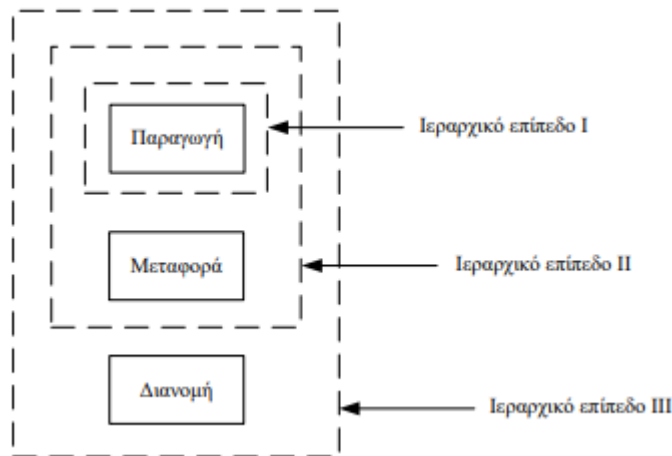
Σχήμα 2 : Επίπεδα ιεράρχησης ενός Συστήματος Ηλεκτρικής Ενέργειας
