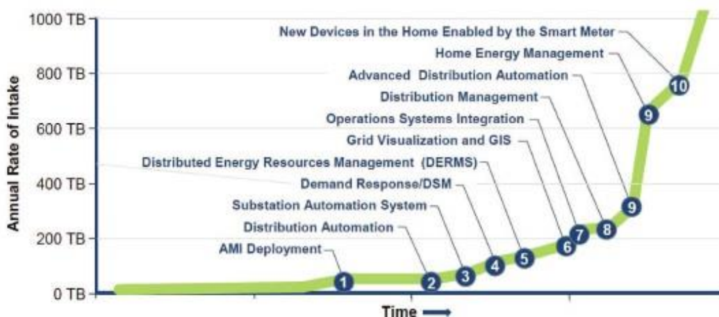
Εικόνα 4.2β: Γράφημα παραγωγής όγκου δεδομένων ενέργειας από τα διάφορα συστήματα και μονάδες των έξυπνων δικτύων [30]
