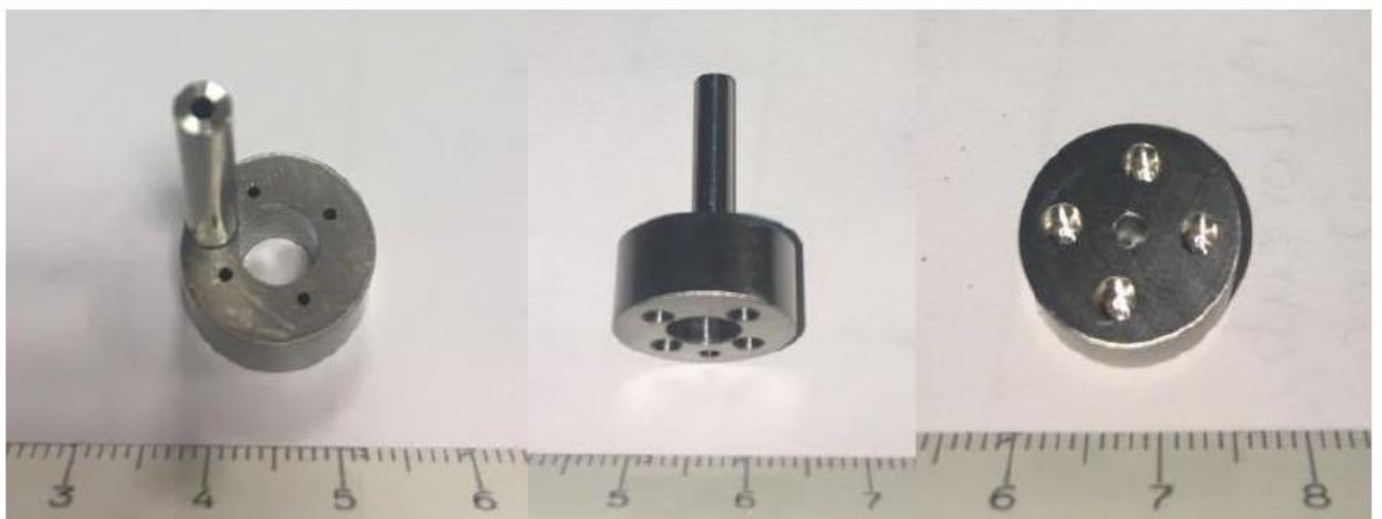
Εικόνα 5.7: Το πάνω τμήμα του αντιδραστήρα μας αριστερά και στο μέσο της εικόνας και το κάτω μέρος του αντιδραστήρα μας δεξιά.
