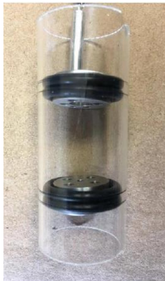
Εικόνα 5.11: Στεγανοποίηση του αντιδραστήρα.
