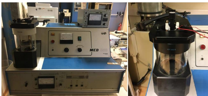
Εικόνα 6.1: Συσκευή θερμικού εξατμιστή (αριστερά), με τον θάλαμο κενού να χρησιμοποιείται ως αντιδραστήρας (δεξιά).
