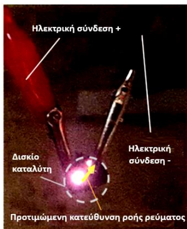
Εικόνα 6.7: Προτιμώμενη διαδρομή ρεύματος κατά μήκος του δισκίου καταλύτη.
