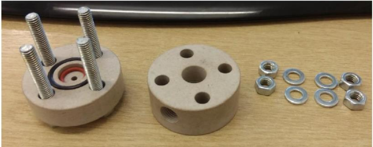
Εικόνα 5.4 Αντιδραστήρας τεφλόν για θερμοκρασία έως 200°C.
