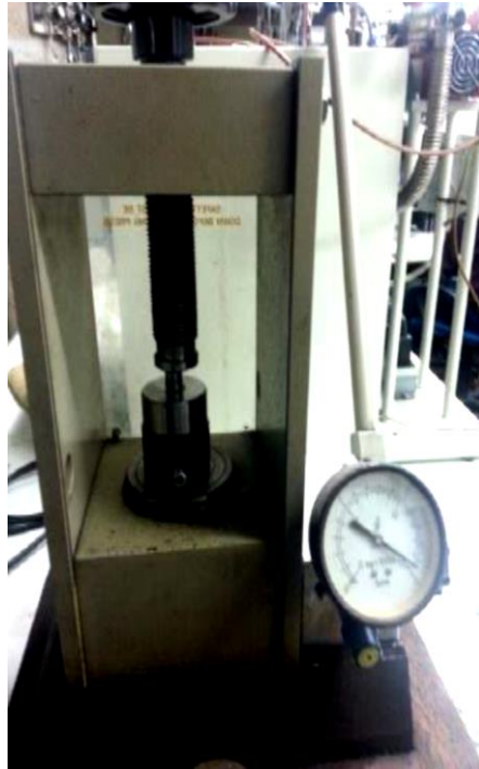
Εικόνα 4.30: Υδραυλική πρέσα Specac 25.011.
