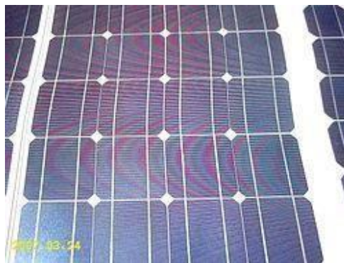
Σχήμα 9.7: Φωτοβολταϊκό από μονοκρυσταλλικό πυρίτιο [67]
