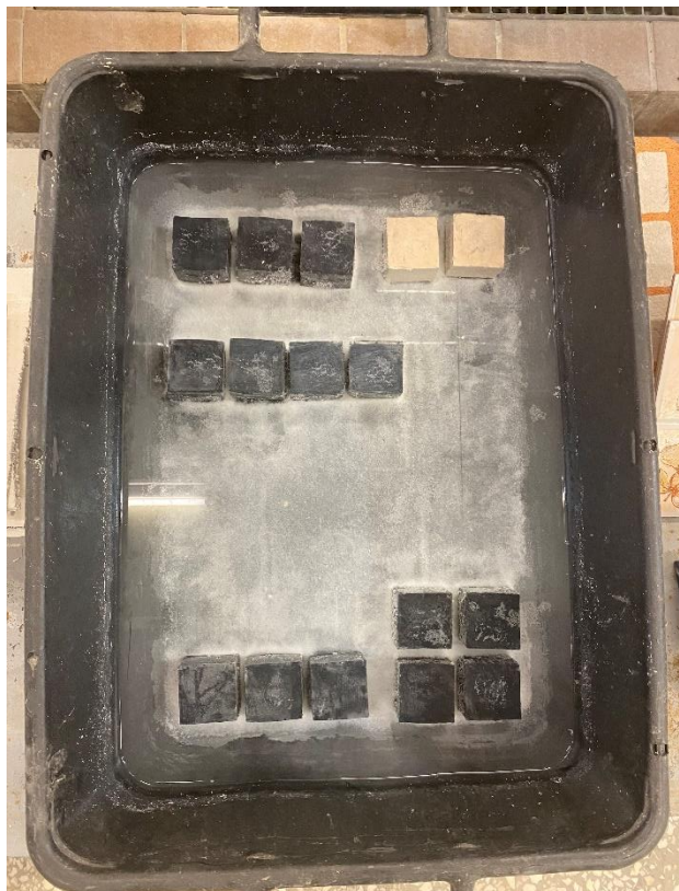
Σχήμα 5.2 (α) Δοκίμια μετά τις 24 ώρες στο δοχείο εμφύσησης για συντήρηση 28 ημερών (β) Πλανητικό mixer ανάδευσης συνθέσεων και ογκομετρικός σωλήνας μέτρησης ποσότητας νερού (γ) Δοκίμιο 5x5x5cm από την τέταρτη (Δ') σύνθεση
