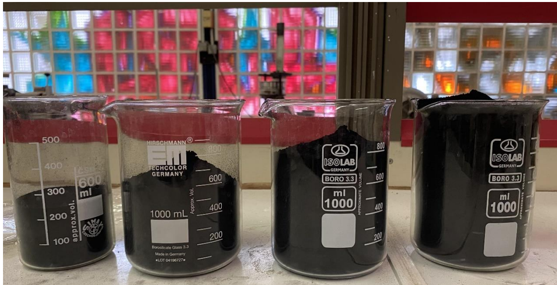
Σχήμα 5.3 Ογκομετρικές ποσότητες carbon black για τις τέσσερις συνθέσεις
