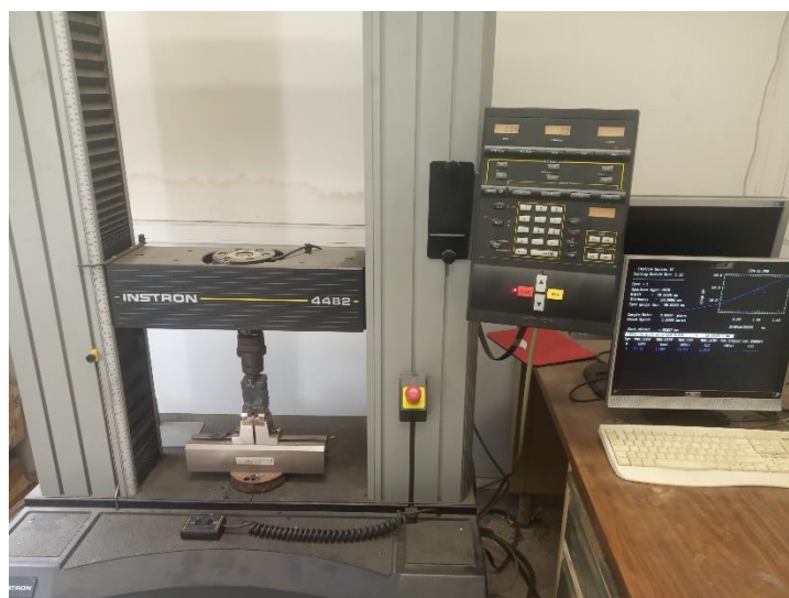
Σχήμα 5.4 Πειραματική διάταξη Instron® 4482 dual-column Universal Testing Machine για μέτρηση θλιπτικής τάσης
