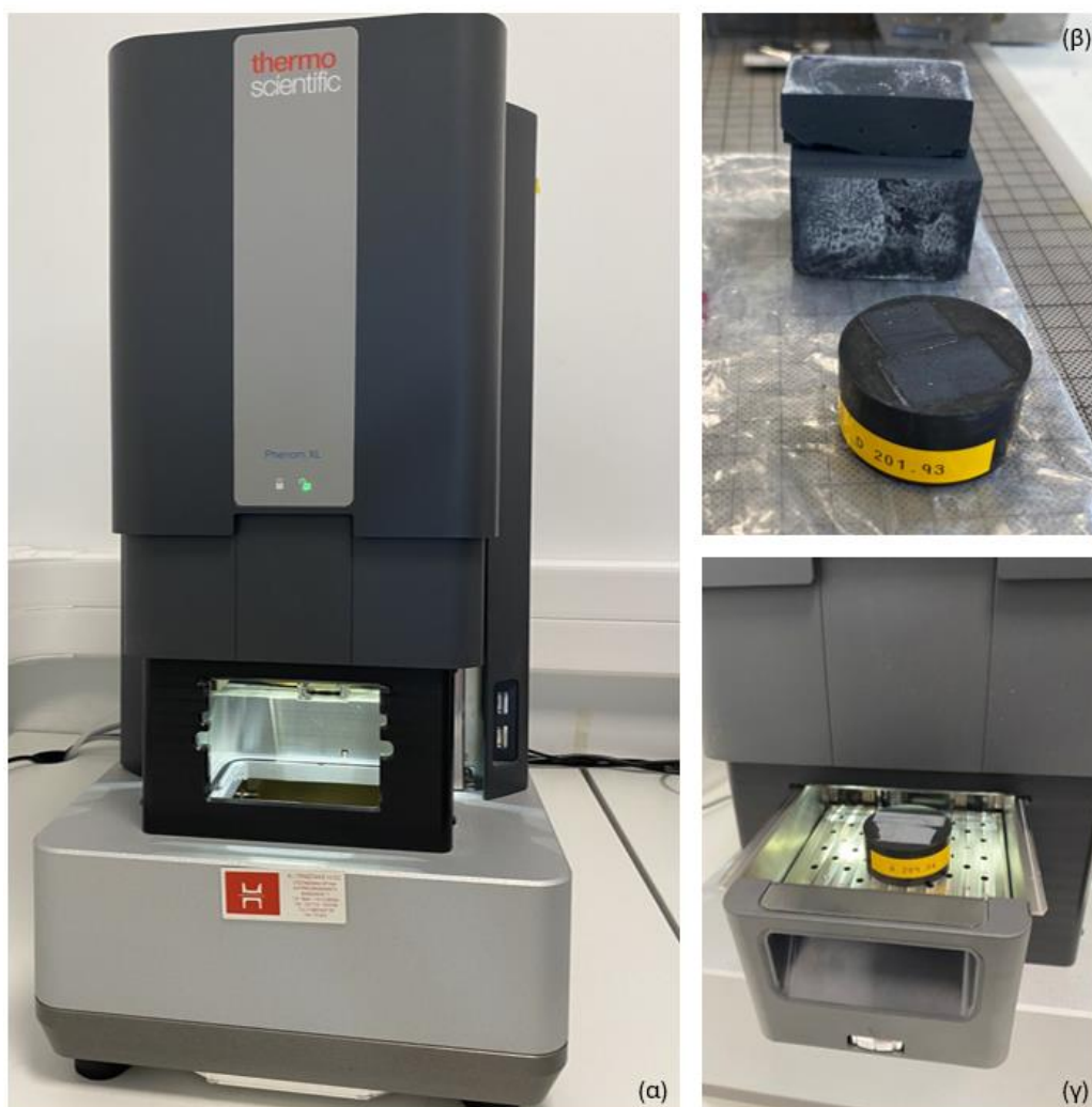
Σχήμα 5.9 (α) SEM Thermo Scientific Phenom XL του ΚΔΕΠ ΔΕΗ (β) Το δείγμα εμβαπτισμένο σε εποξική ρητίνη που προετοιμάστηκε από το τεμαχισμό του δοκιμίου Δ.3 (γ) το δείγμα κατά την εισαγωγή του στο SEM
