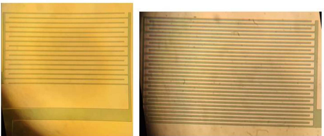
Σχήμα 33 : Αποτελέσματα θετικής λιθογραφίας για 30 και 10 \mu\text{m}
