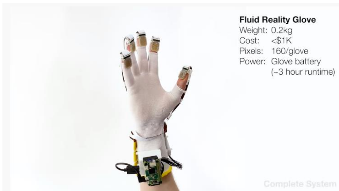
Εικόνα 34: Ο απτικός μηχανισμός της εταιρείας Fluid Reality [59]
