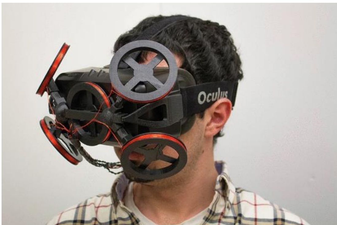
Εικόνα 33: Ένα VR HMD Eye tracking της εταιρίας Oculus [57]
