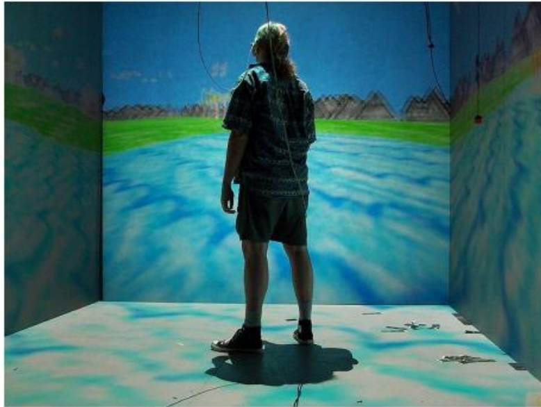
Εικόνα 9: Παράδειγμα ενός Cave Automatic Virtual Environment [10]
