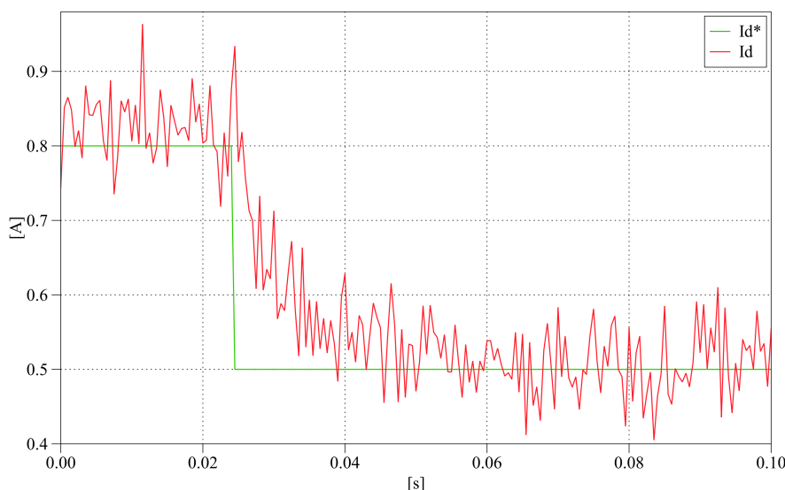
Σχήμα 4.12: Απόκριση ρεύματος I_d
