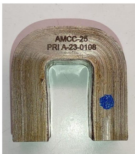
Εικόνα 33: Πυρήνας πηνίου διέγερσης από άμορφο κράμα σιδήρου.
