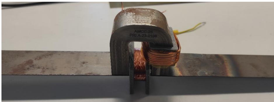
Εικόνα 38: Συνολική διάταξη πηνίων λήψης και διέγερσης.
