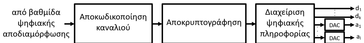
Σχήμα 1.15: Λειτουργικό διάγραμμα βαθμίδας βασικής ζώνης του ψηφιακού συστήματος λήψης
