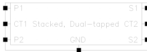
Σχήμα 3.43: Stacked, Dual-tapped: Σύμβολο του extracted model
