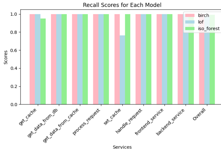
Σχήμα 4.5: Πείραμα 1, Ανωμαλίες DB Connection Limit, Αποτελέσματα Μετρικής Recall
