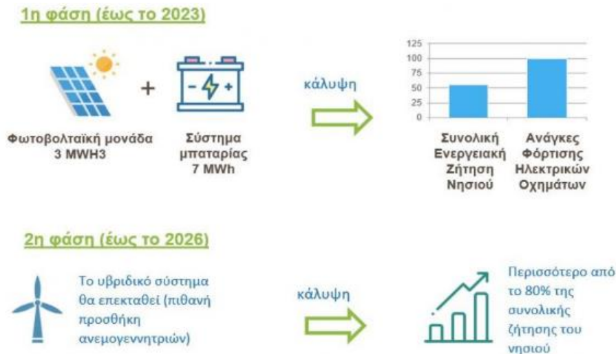
Εικόνα 2.25: Τα σχέδια του προγράμματος ASSI για την δημιουργία ενός μικροδικτύου στην Αστυπάλαια [71].
