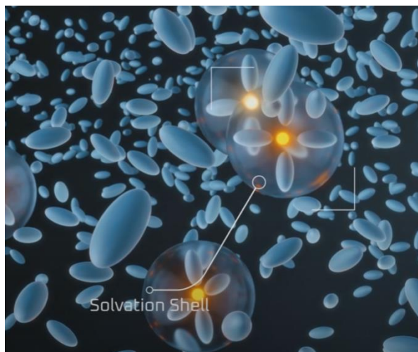
Εικόνα 2.4.2: Η απορρόφηση του κατιόντος λιθίου από το διαλυτικό του ηλεκτρολύτη [7]
