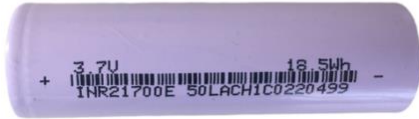
Εικόνα 5.1.2: Το κελί INR21700E που χρησιμοποιήθηκε στις συστοιχίες συσσωρευτών των πειραμάτων [4]
