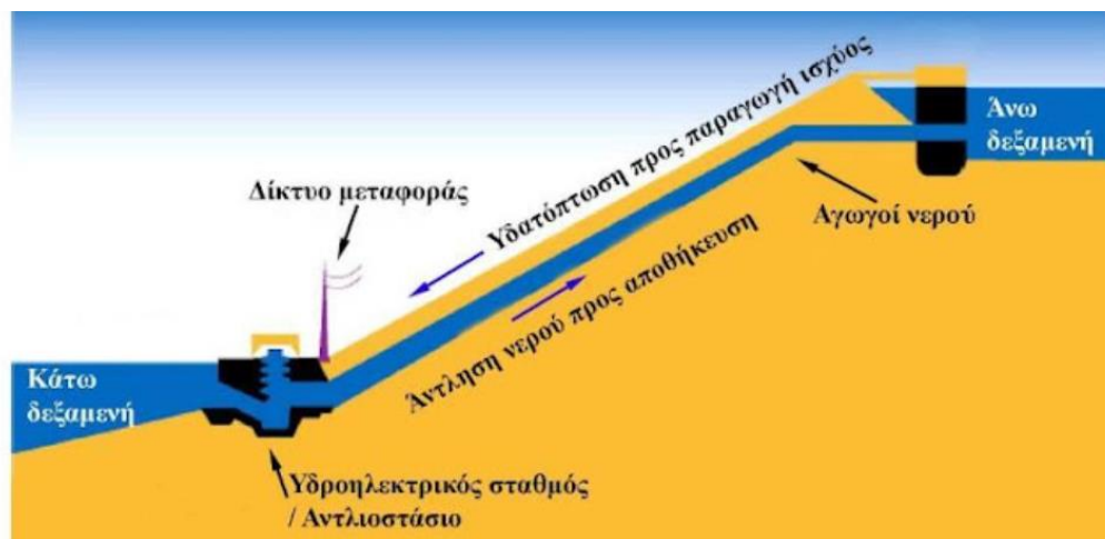
Εικόνα 3: Εικόνα σταθμού αποθήκευσης με χρήση αντλησιοταμίευσης. [34]
