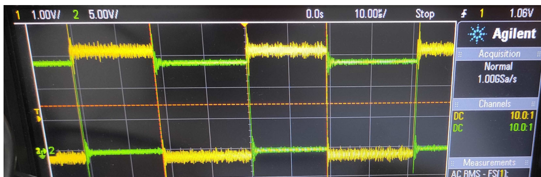
Σχήμα 5.7: Σήμα PWM και τάση εξόδου της αντίστοιχης φάσης
