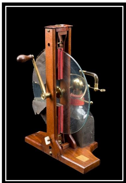
Σχήμα 17 Ηλεκτροστατική μηχανή του Carl Winter, διακρίνουμε τα δακτυλίδια επαγωγής [23]
