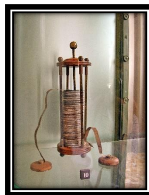
Σχήμα 19 Η βολταϊκή στήλη του Alessandro Volta [6]
