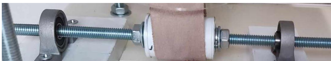
Σχήμα 67 Ο κάτω άξονας μαζί με τον κύλινδρο και περασμένο τον ιμάντα
