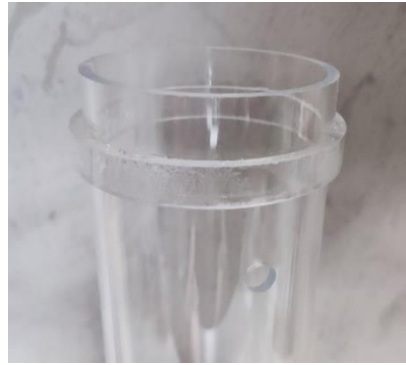
Σχήμα 49 Το δαχτυλίδι από plexiglass που κολλήσαμε για να στερεώνεται η σφαίρα
