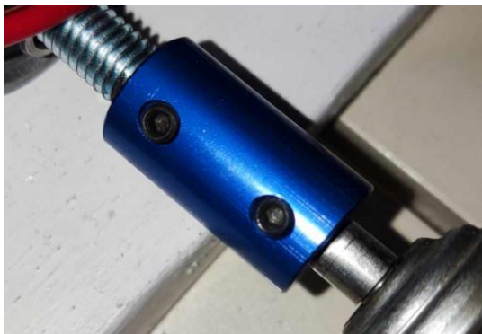
Σχήμα 59 Ο αντάπτορας που συνδέει το μοτέρ με τον κάτω άξονα
