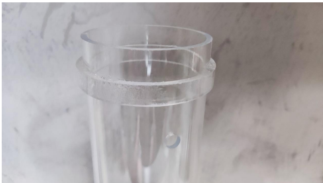
Σχήμα 64 Η στήλη στήριξης με την τρύπα που έχουμε κάνει στον άνω άξονα και το δαχτυλίδι που έχουμε προσαρμόσει για την στήριξη της σφαίρας
