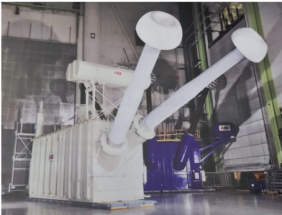
Σχήμα 42 Μετασχηματιστής σταθμού μετατροπής (converter transformer) εναλλασσόμενου / συνεχούς ρεύματος (E.P. / Σ. Ρ.) 800 kV, σε αίθουσα δοκιμών [39]
