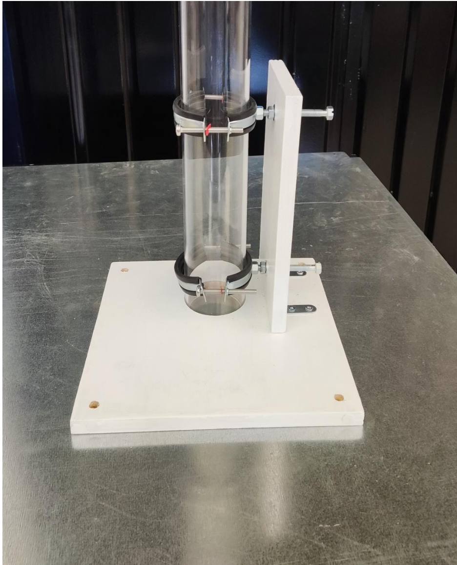
Σχήμα 62 Η άνω βάση με την στήλη plexiglass και τους σφυκτήρες να την συγκρατούν
