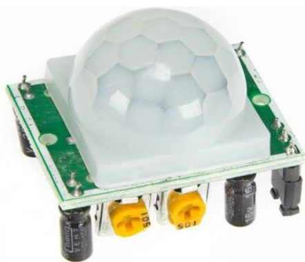
Εικόνα 40: Αισθητήρας PIR με φακό Fresnel
