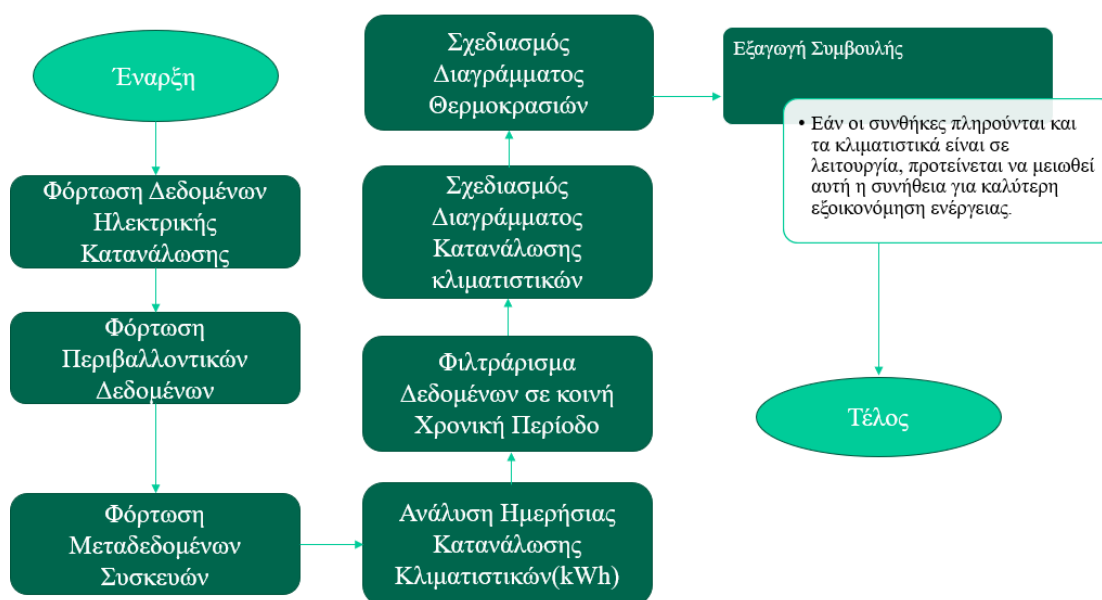
Σχήμα 5.16: Διάγραμμα ροής κατανάλωσης κλιματισμού με εξωτερική θερμοκρασία
