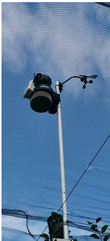
Εικόνα 6: Αισθητήρας παραμέτρων καιρού
