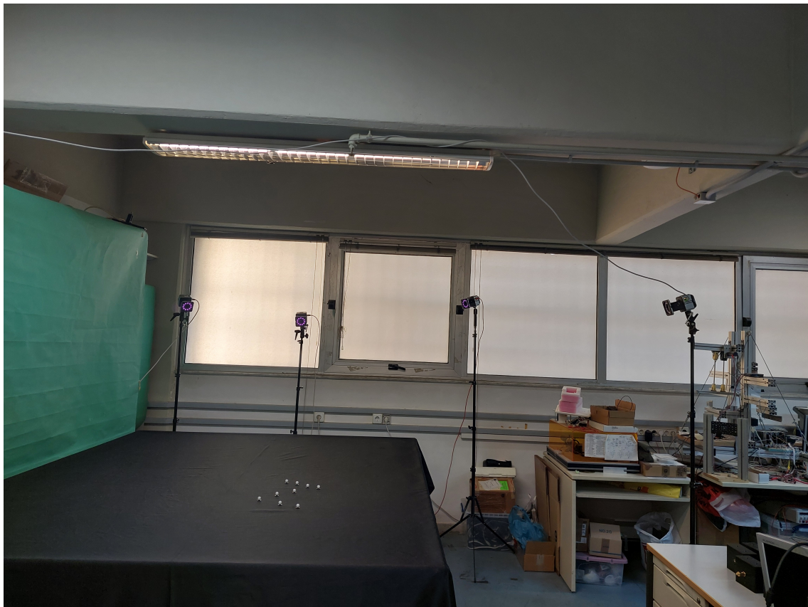
Σχήμα 5.4: Οι κάμερες του συστήματος Vicon περιμετρικά της τράπεζας γρανίτη και οι markers.
