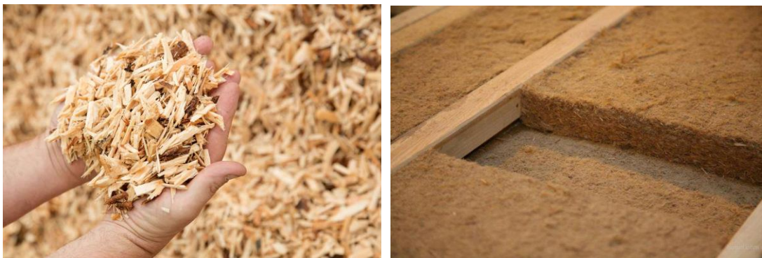
Σχήμα 2.10: Ξυλόμαλλο πριν (αριστερά) και μετά την επεξεργασία (δεξιά).
