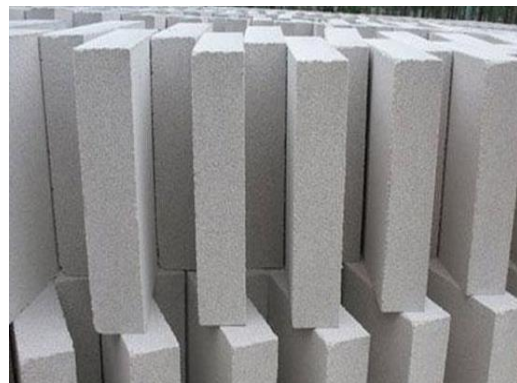
Σχήμα 2.6: Διογκωμένος περλίτης σε κόκκους (αριστερά) και σε πάνελ (δεξιά).
