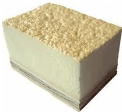
Σχήμα 2.5: Πάνελ πολυουρεθάνης (αριστερά) και εφαρμογή αφρού πολυουρεθάνης (δεξιά).
