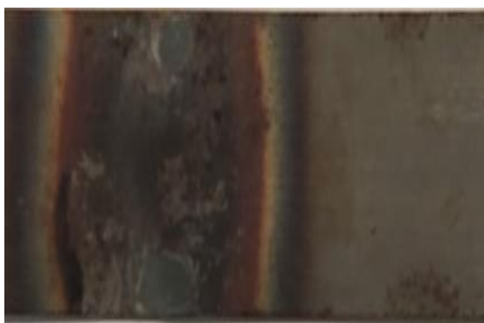
Ε) Χρωματιστές κηλίδες θερμικής καταπόνησης [18].
