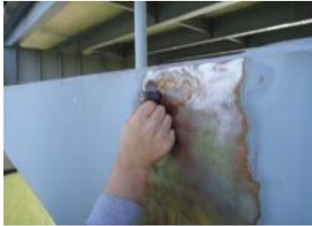
Εικόνα 18: Έλεγχος με αισθητήρα UT [28].
