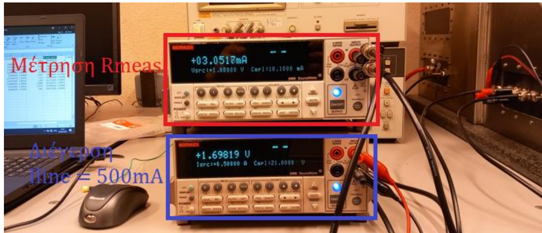
Εικόνα 58: Πειραματική Διάταξη με τα 2 SourceMeters συνδεδεμένα με το probe station.
