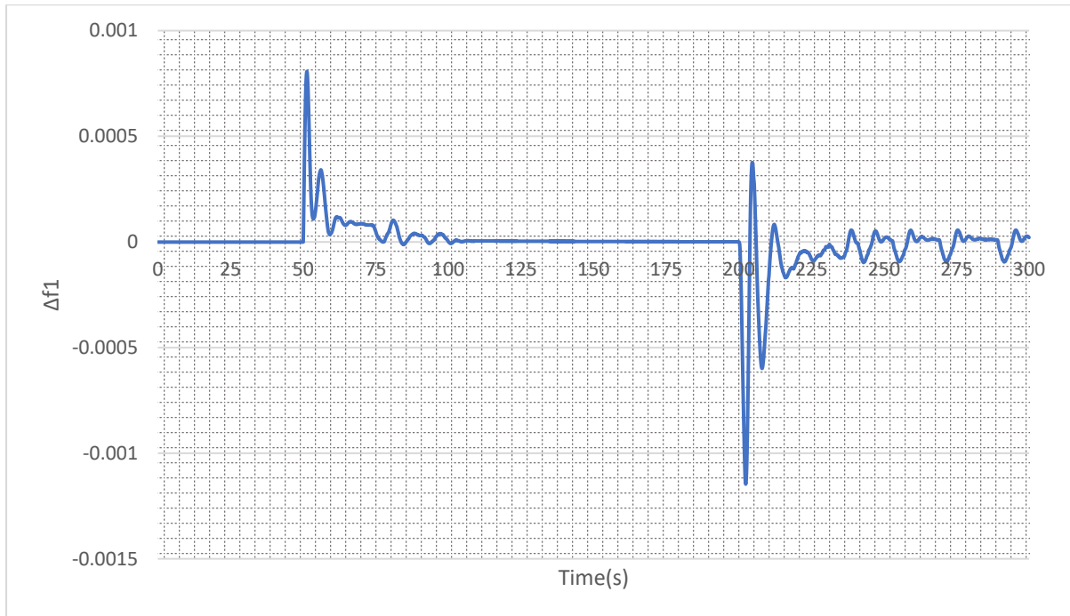
Σχήμα 44: Απόκριση συχνότητας συστήματος με DRL^2FC σε FDIA στη μέτρηση συχνότητας και στη μέτρηση διασυνδετικής ισχύος υπό διαχείριση μεταβολής φορτίου 0.01 α.μ.
