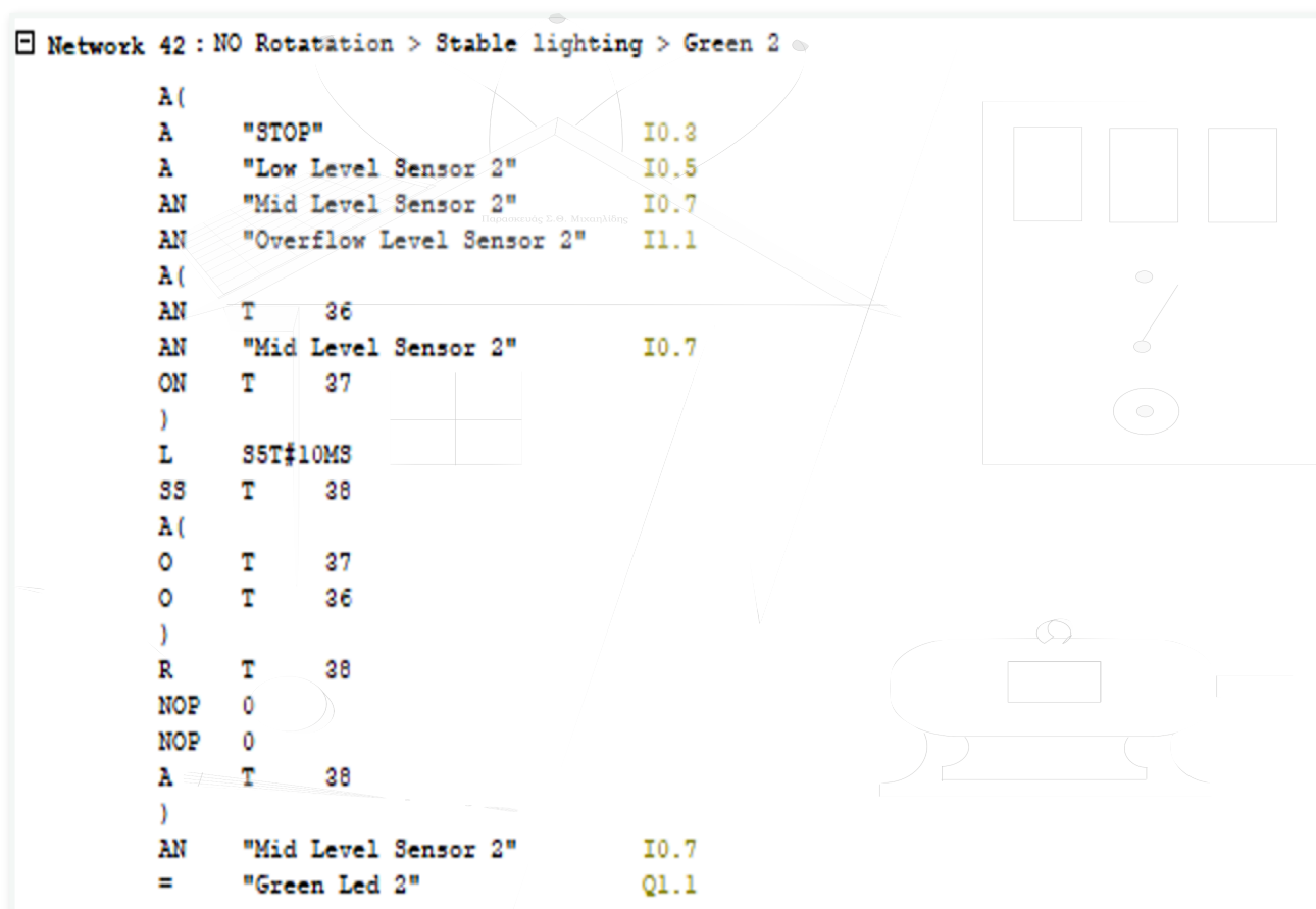
Εικόνα 2.85: Pumping Station's Network 42 - STL Code
