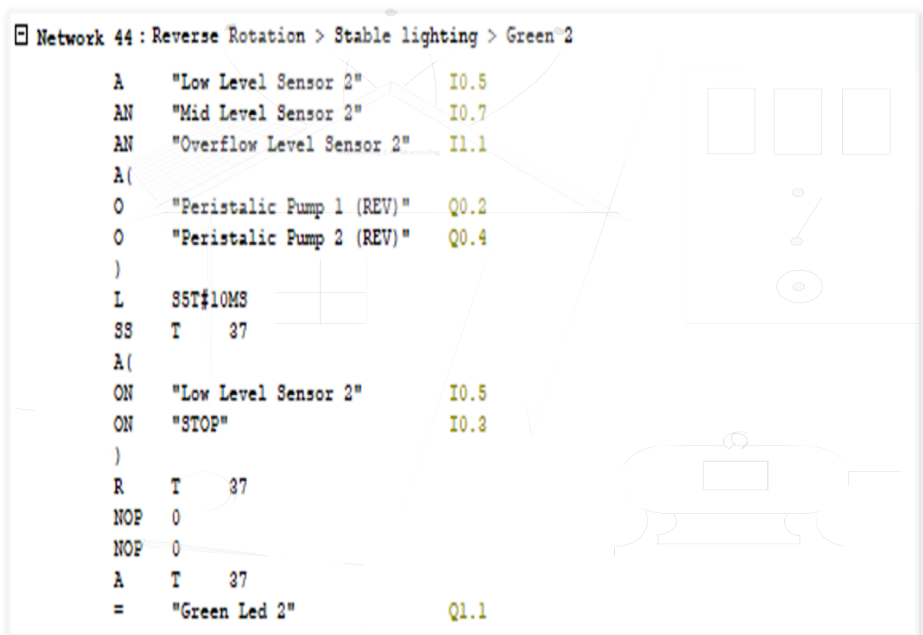
Εικόνα 2.89: Pumping Station's Network 44 - STL Code
