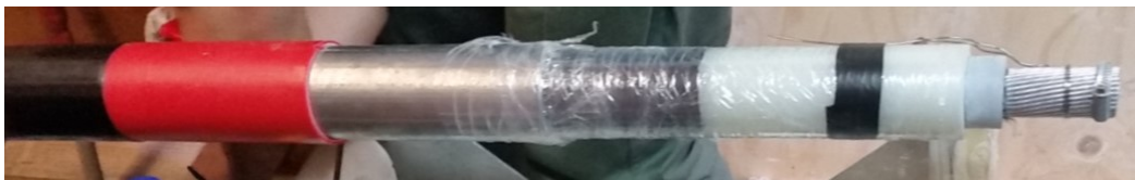
Εικόνα 3.13 Στρώματα που απαρτίζουν ένα καλώδιο YT 150kV τύπου XLPE
