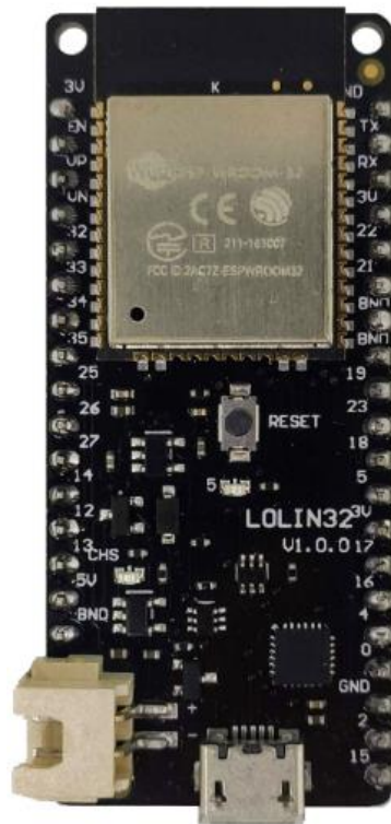
Σχήμα 33: Διαμόρφωση των ακίδων του Wemos Lolin32
