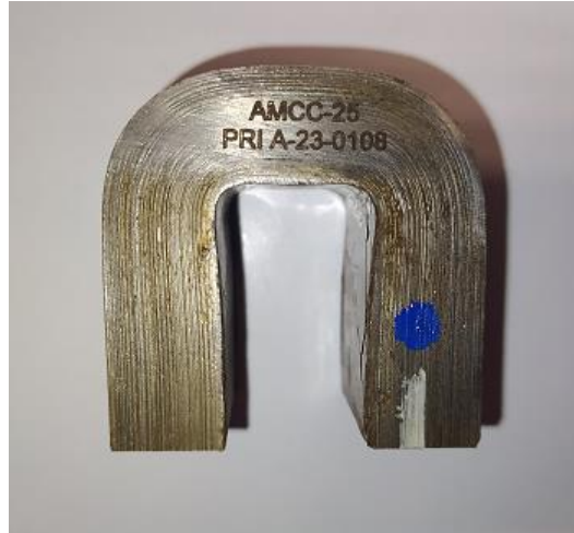
Σχήμα 42: Ο σιδηρομαγνητικός πυρήνας του αισθητήρα
