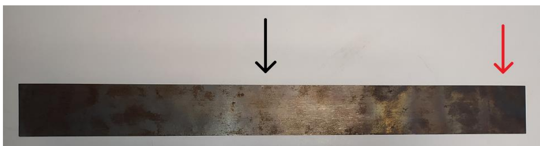
Σχήμα 46: Οι δύο περιοχές του χάλυβα στις οποίες πραγματοποιήθηκαν οι μετρήσεις. Το μαύρο βέλος δείχνει την περιοχή όπου οι παραμένουσες τάσεις απουσιάζουν, ενώ το κόκκινο δείχνει αυτήν όπου οι παραμένουσες τάσεις υπάρχουν
