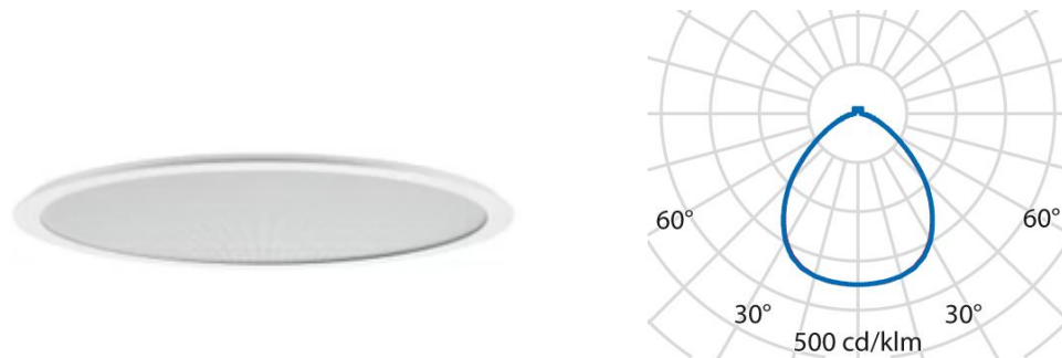
Σχήμα 4.33 Φωτιστικό SL713AB και πολικό διάγραμμα
