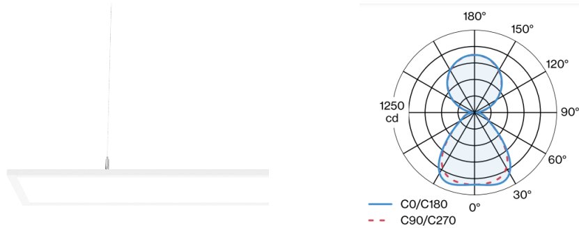
Σχήμα 4.69 Φωτιστικό DESO 40 και πολικό διάγραμμα
