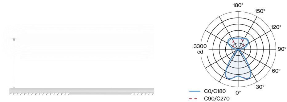
Σχήμα 4.57 Φωτιστικό SETA και πολικό διάγραμμα
