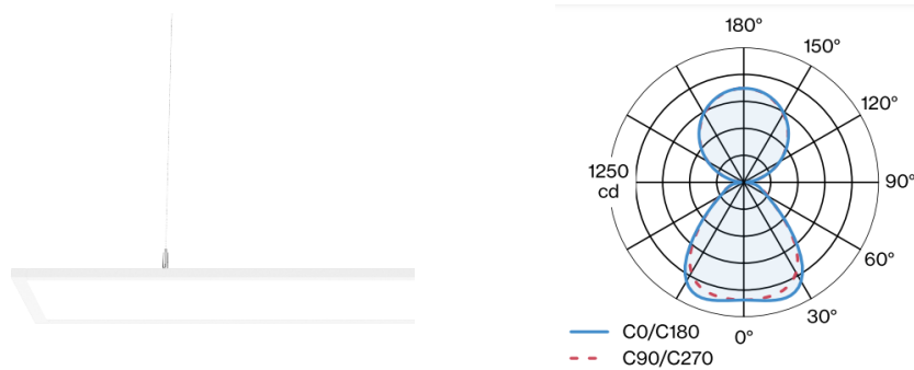
Σχήμα 4.53 Φωτιστικό DESO 40 και πολικό διάγραμμα
