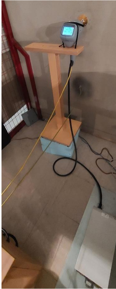
Εικόνα 3.13. Διάταξη διακρίβωσης της γεννήτριας NSG 438 (SCHAFFNER)
