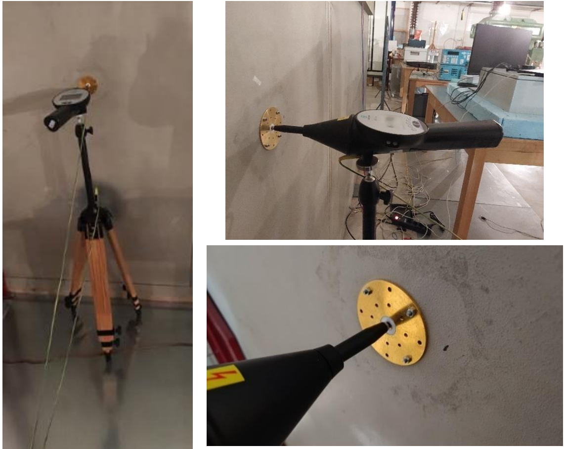
Εικόνα 3.11. Διάταξη διακρίβωσης της γεννήτριας EMTEST DITO
