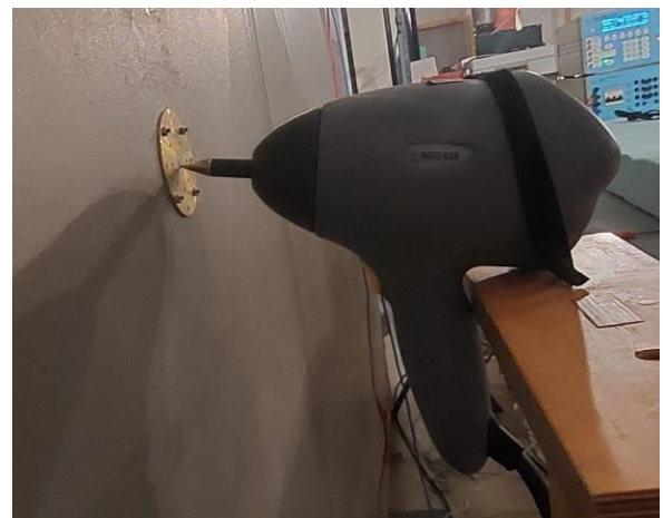
Εικόνα 3.13. Διάταξη διακρίβωσης της γεννήτριας NSG 438 (SCHAFFNER)
