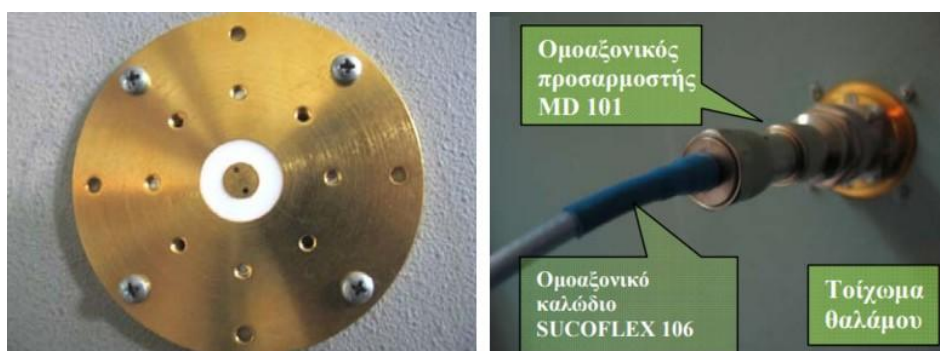
Σχήμα 3.4: Ο ομοαξονικός προσαρμοστής τοποθετημένος στη διάταξη MD 103 [2]
