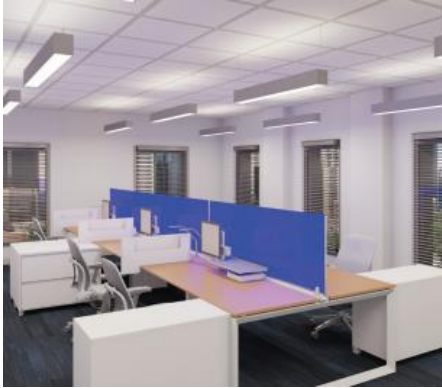
Εικόνα 13 Τα φωτεινά χωρίσματα θέσεων εργασίας μπορούν να χρησιμοποιηθούν για την παροχή επιπλέον CS στους χρήστες ενός χώρου [33].
