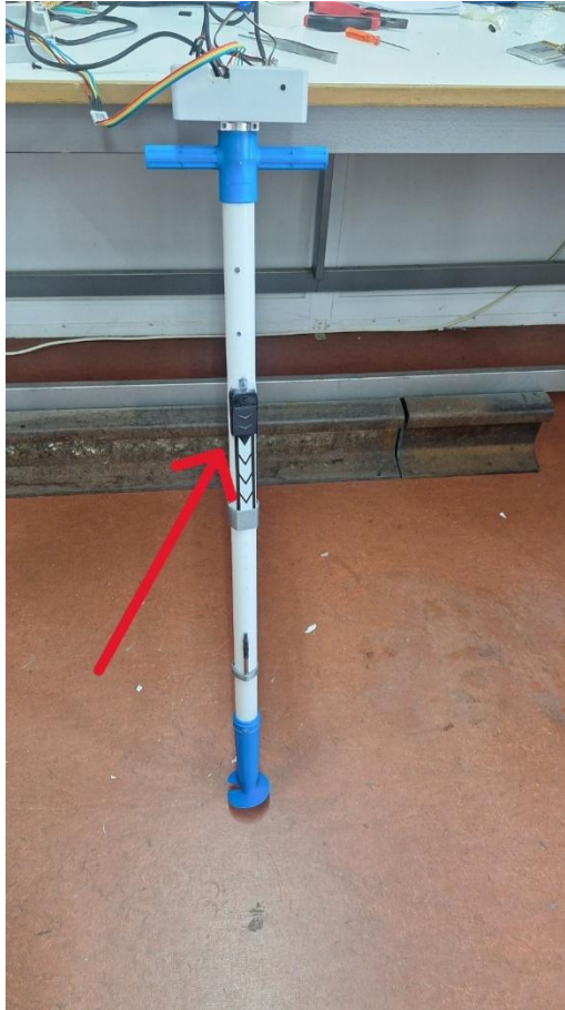
Σχήμα 2.25: Αισθητήρας υγρασίας SEN0308 πάνω στο Stick.
