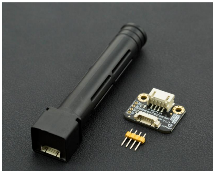
Σχήμα 2.6: Αισθητήρας Διοξειδίου του Άνθρακα (CO 2 ) SKU SEN0220. [107]
