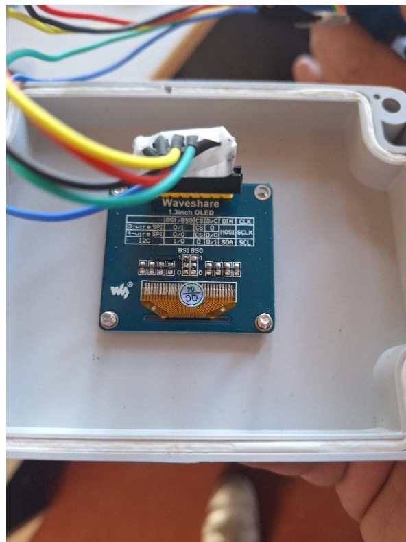
Σχήμα 2.13: Κοντινή Όψη Οθόνης OLED.
