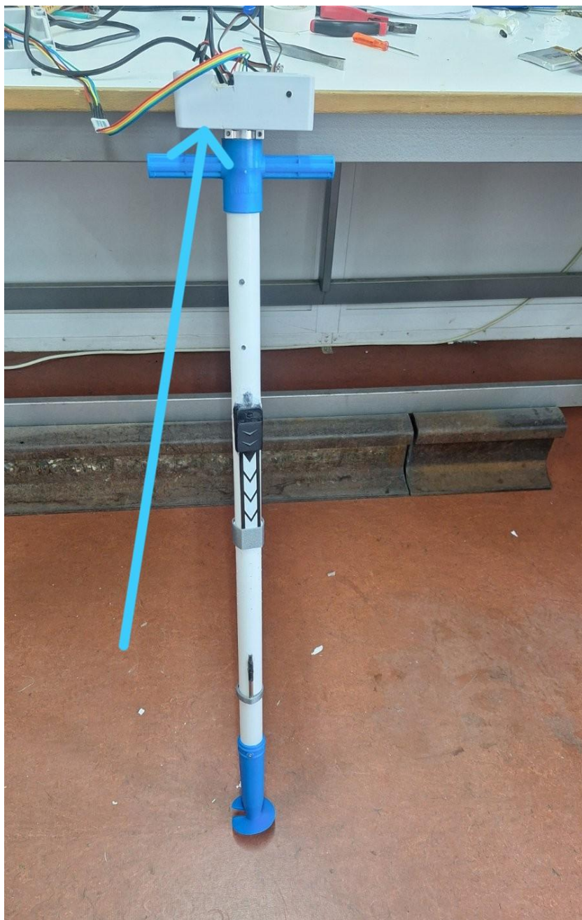
Σχήμα 2.23: Περίβλημα Διάταξης Hardware στη συνολική διάταξη του Stick.
