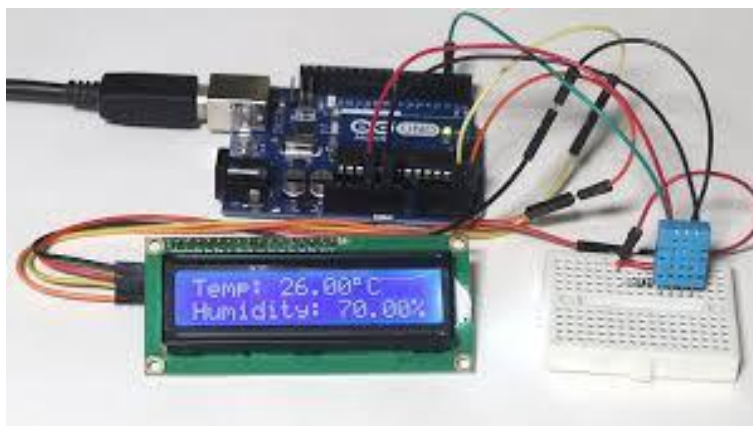
Σχήμα 1.28: Ολοκληρωμένο Κύκλωμα Αισθητήρα DHT11 με χρήση Arduino [48]
