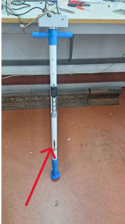
Σχήμα 2.24: Αισθητήρας θερμοκρασίας DS18B20 πάνω στο Stick.
