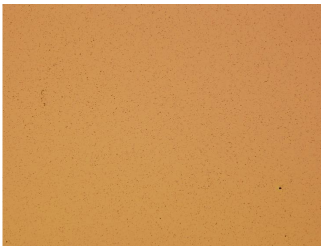
Εικόνα 49: Σχετικώς καθαρό δείγμα ZnO, χρόνου ανάπτυξης 30 λεπτά
