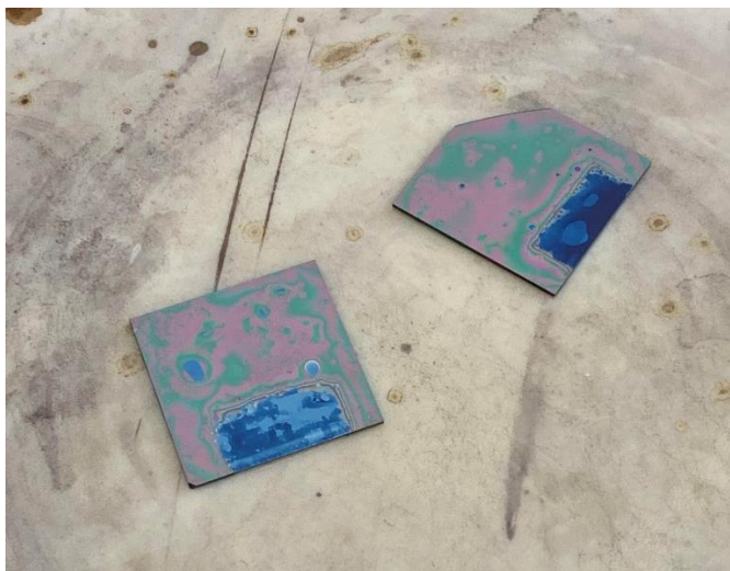
Εικόνα 48: Διαδικασία απομάκρυνσης απομένουσας υγρασίας από ανεπτυγμένα ZnO δείγματα στο hot plate
