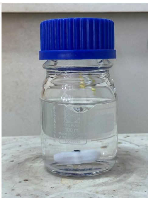
Εικόνα 35: Διαδικασία ανάδευσης του τζελ
